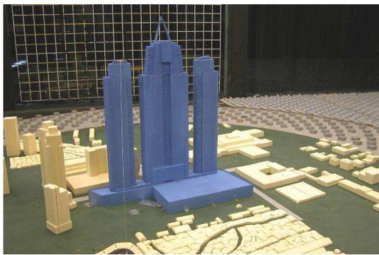
Макет для испытаний в аэродинамической трубе
